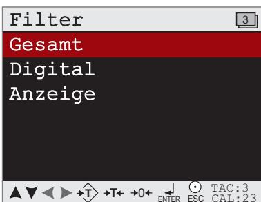
Der analoge Eingangsbereich bis zum A/D-Wandler verfügt über ein 2-stufiges, aktives und einstellbares **Tiefpassfilter**. Dieses Filter ist allen weiteren Filtern vorgeschaltet und heißt deshalb auch „**Gesamt-Filter**“.
